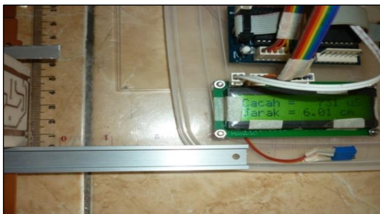
Gambar 8. Perbandingan Pengukuran LCD dengan Mistar
